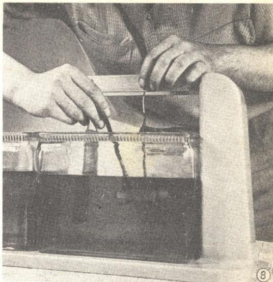
Successivamente si fa depositare sul martello un sottilissimo strato di nichel, sospendendo l'utensile in una soluzione al nichel, per la durata di due o tre minuti (foto N. 8). Le bolle che eventualmente si formano sulla sua superficie devono essere eliminate con uno spazzolino. Il martello viene poi trasferito entro la vaschetta con la soluzione di rame (foto N. 9) per ricevere una sostanziale ramatura, che serve come sotto armatura per la nichelatura finale.
