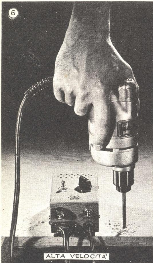
Punte da trapano di piccolo diametro tagliano meglio a velocità elevate. Punte elicoidali fino a 12 mm. di diametro, lavorano bene nel legno, nell'alluminio o in altri materiali teneri alle normali velocità dei piccoli motori per trapani elettrici. Per l'acciaio occorrono velocità meno elevate se non si impiegano punte finissime.
