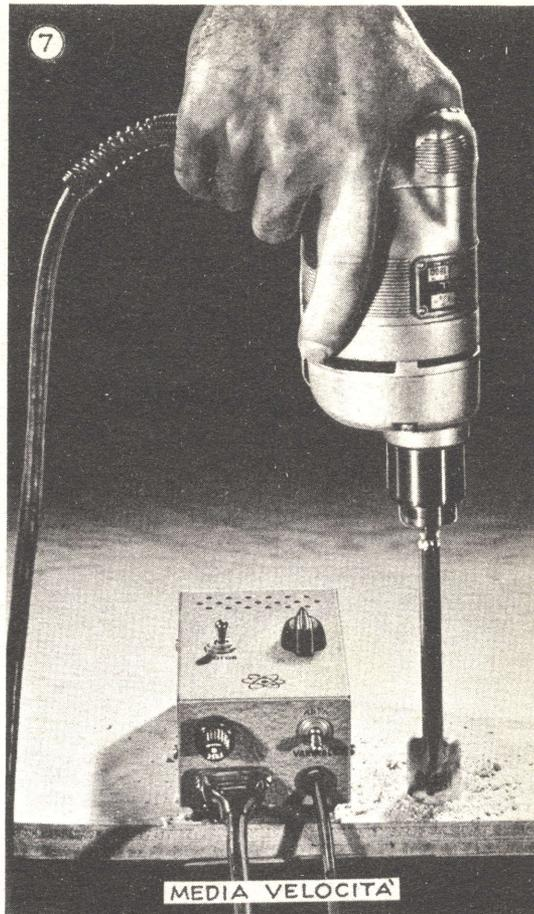
Punte a lancia di medie dimensioni lavorano meglio a velocità ridotte, ottenendo un taglio più netto, controllando più facilmente il trapano e l'orlo tagliente rimane affilato più a lungo. Per forare l'acciaio con punte di acciaio al carbonio si devono impiegare velocità più lente.
